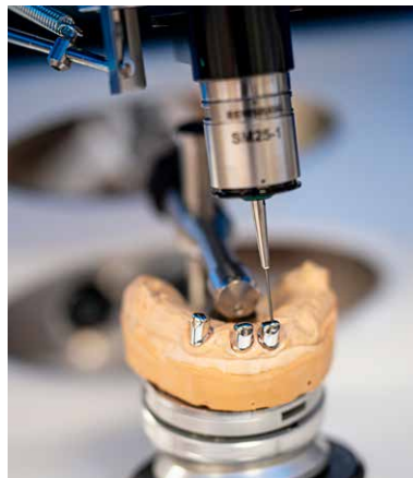
Ein taktiler Scanner ermittelt Daten für die präzise Zahnersatz-Herstellung.
